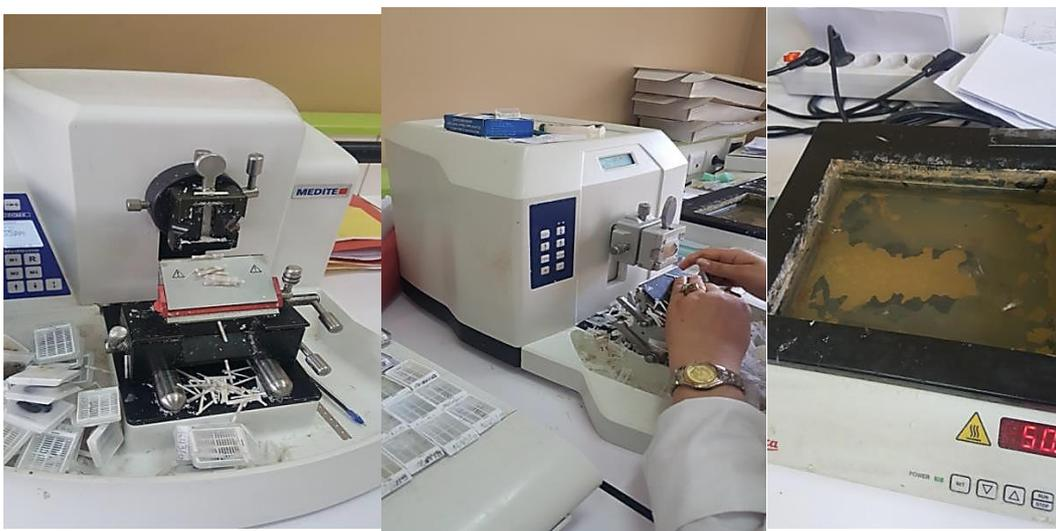
Figure 10 : Démoulage des blocs de paraffine.
